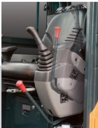
Una consola basculable en el lado izquierdo facilita la entrada y la salida de la cabina.
